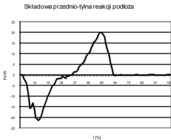
Rys. 9 Reakcje podłoża składowej przednio-tylnej dla prawej kończyny dolnej dziecka w czasie pojedynczego cyklu chodu
