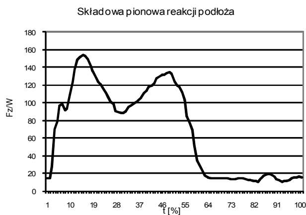
Rys. 8 Reakcje podłoża składowej pionowej dla prawej kończyny dolnej dziecka w czasie pojedynczego cyklu chodu
