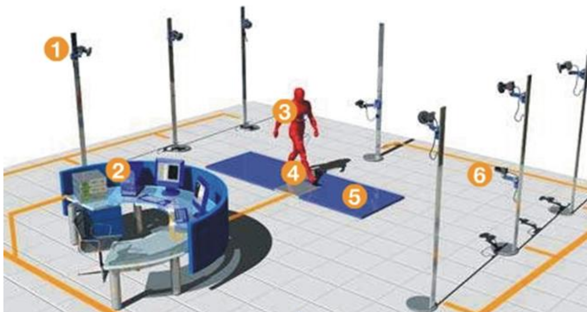
Rys.1. Rozmieszczenie komponentów Sytemu BTS Smart (1-kamery na podczerwień, 2-stanowisko robocze, 3-przenośny zestaw do EMG, 4-markery, 5-platforma dynamograficzna, 6-kamery wideo) [2]
