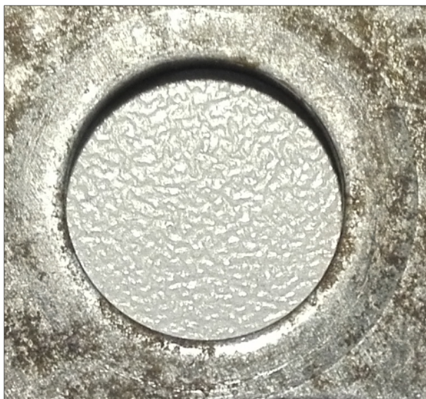
Rys. 13. Powierzchnia oporowa podkładki o twardości 40,45 HRC, na której ślady bruzdowania nie wystąpiły
