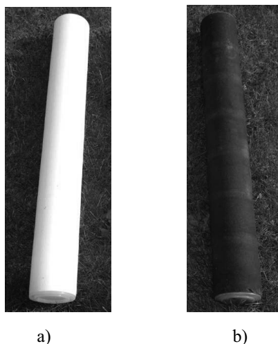
Rys. 3. Filtr świecowy: a) nowy, b) zanieczyszczony osadami
