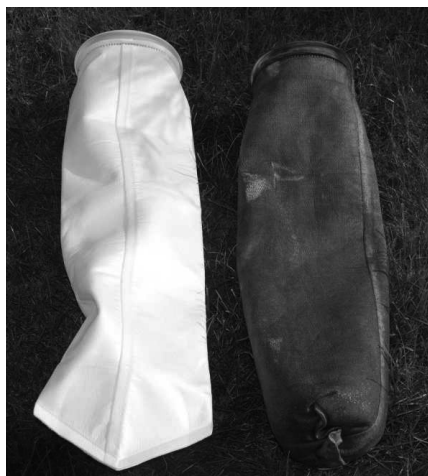
Rys. 2. Filtr workowy: a) nowy, b) zanieczyszczony osadami
