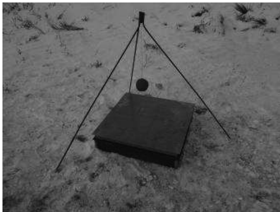
Rys. 4. Ogólny widok stanowiska do testowania paneli obciążonych dużymi ładunkami wybuchowymi
