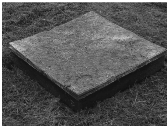
Rys. 5. Panel energochłonny ze strukturą w postaci aramidowego plastra miodu po obciążeniu falą ciśnienia pochodzącą z detonacji materiału wybuchowego
