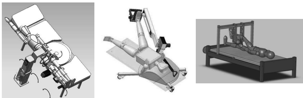
Rys. 3. Wybrane koncepcje urządzenia do rehabilitacji kończyn dolnych opracowane w ramach projektu
