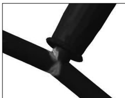
Rys.4. Koncentracja naprężeń w uchwycie rączki kuli ortopedycznej
