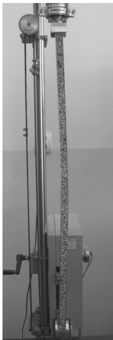
Rys.5. Wyboczenie ściskanej osiowo belki-słupa trójwarstwowego – badania doświadczalne
