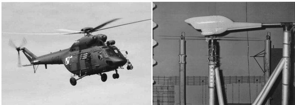
Rys.1. Śmigłowiec PZL W-3 Sokół i jego dynamicznie podobny model w trakcie badań w tunelu aerodynamicznym
