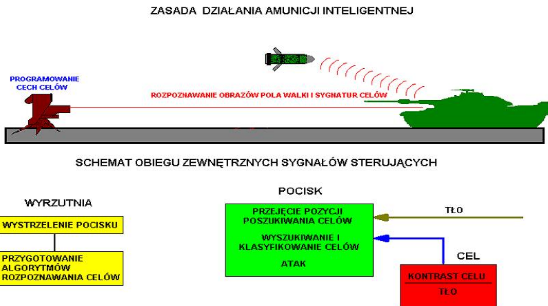
Rys. 1 Zasada działania amunicji inteligentnej
